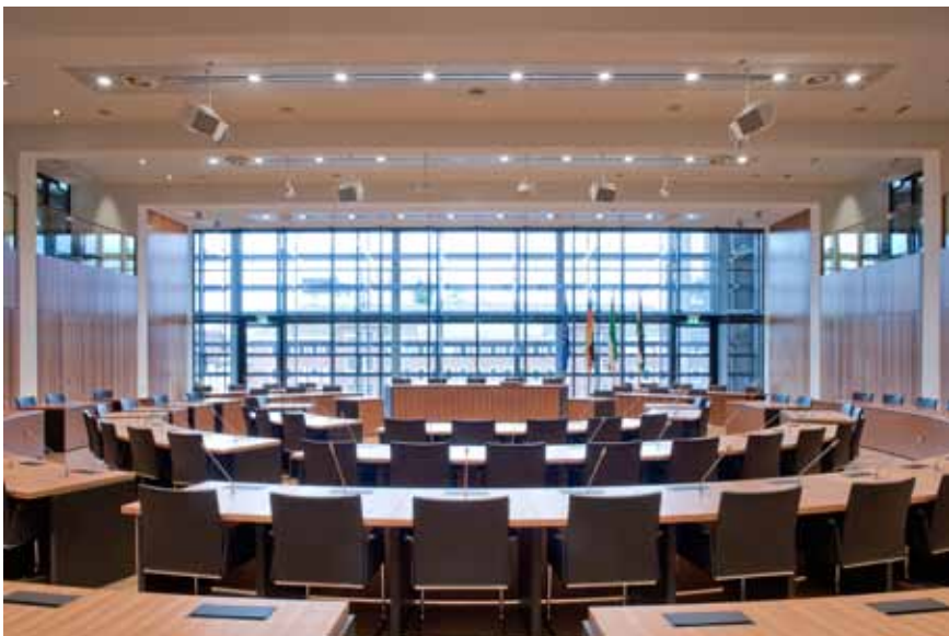
Downlights mit objektbezogen berechneten Reflektoren, mit definierten asymmetrischen Ausstrahlungswinkeln
